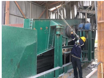
รูปที่ 3-30: การตรวจวัดค่าความทึบแสง บริเวณตะแกรงสั่น
