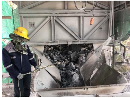
รูปที่ 3-28: การตรวจวัดค่าความทึบแสง บริเวณปากไม่แรก
