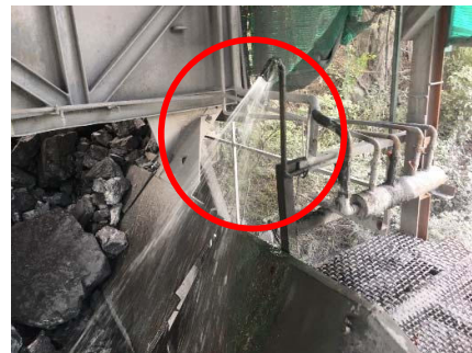
รูปที่ 2-20: ระบบสเปรย์น้ำของโรงโม่
